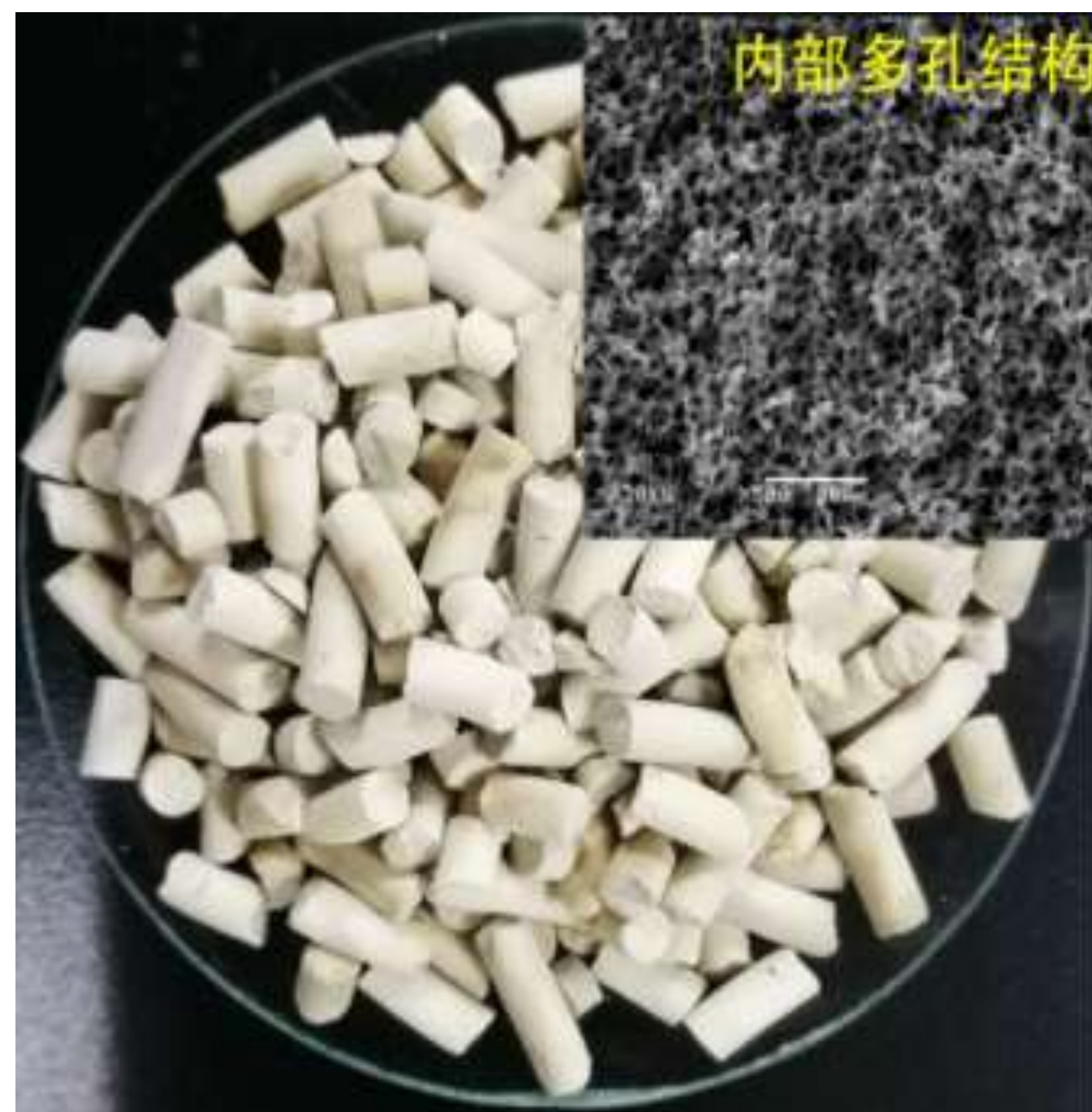
三维网络吸附剂内部孔结构及对亚甲蓝吸附性能
