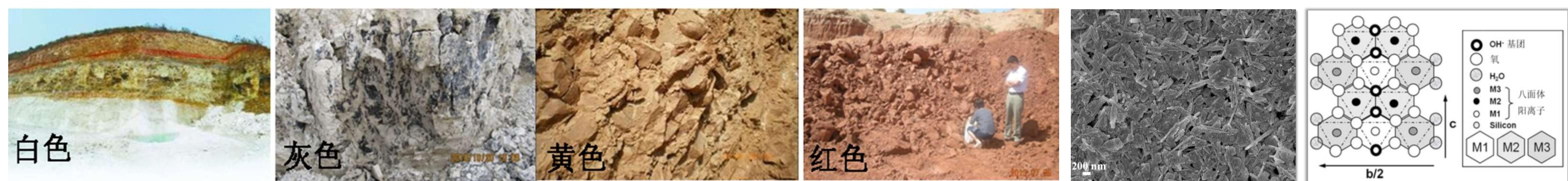
★ 开发了具有自主知识产权的红色凹凸棒石还原转白和溶出转白关键制备工艺，在保持凹凸棒石原有棒晶和纳米孔道结构的前提下，实现了红色凹凸棒石转白，产品白度大于85，可满足凹凸棒石在锂离子电池隔膜、高分子材料补强剂、水性涂料、功能载体等高端应用需求。
