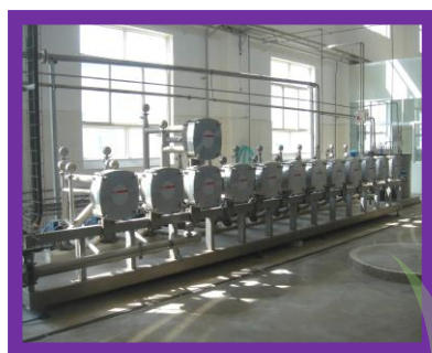
蛋白分离回收装备可与淀粉分离旋流站直接连接
